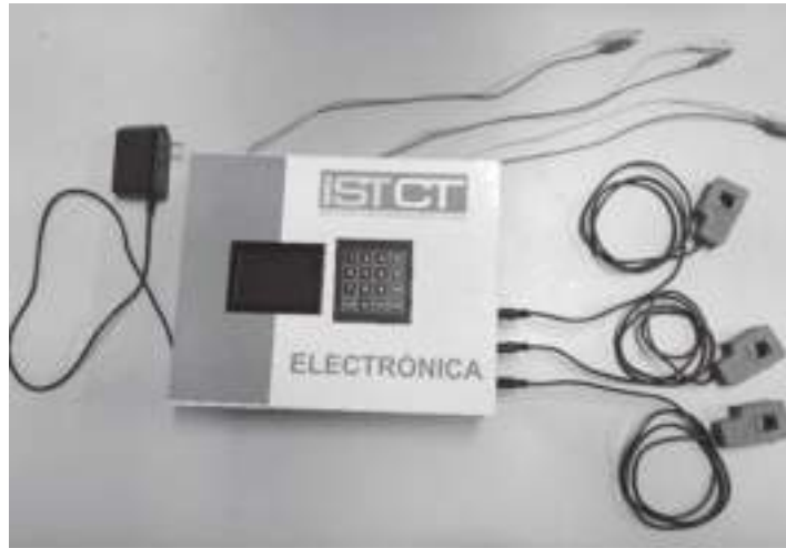
Figura 13. Prototipo de Analizador de Red Trifásica Descripción: Elaboración propia
