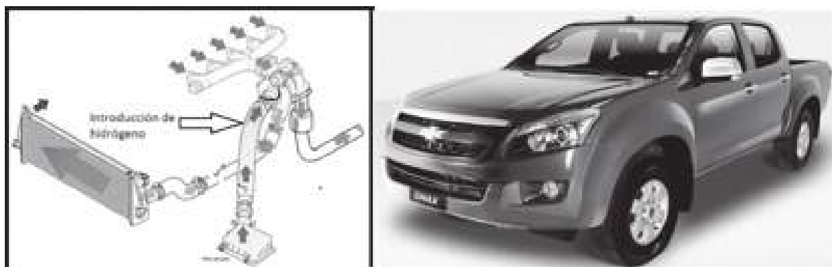
Figura 3. Vehículo y lugar de conexión de la alimentación del generador
